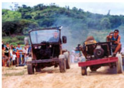
**Das Fahrwerk stammt von einem alten Toyota, die Sitze aus einem VW-Bus, der Motor aus einer Wasserpumpe, die früher einmal bei der Goldsuche verwendet wurde. Zusammengebaut ergeben diese Einzelteile einen Paco Paco. Der Klang des Motors hat der einzigen brasilianischen Automarke ihren Namen gegeben. "360° - Die Geo-Reportage" zeigte,**
